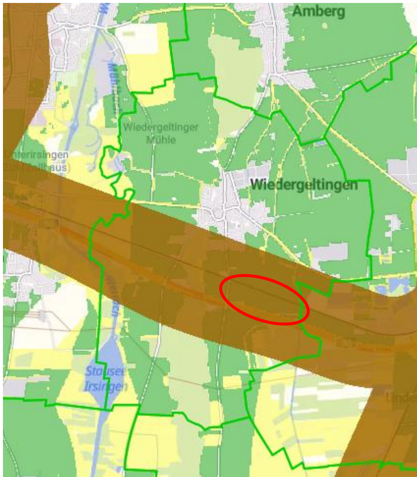
Abb. 2 Gemäß EnergieAtlas geeignete Freiflächen-PV-Standorte (2025) 11 grün = vrsl. geeignet gelb = bedingt geeignet braun = Förderbereich EEG 500 m beidseits der Autobahn
